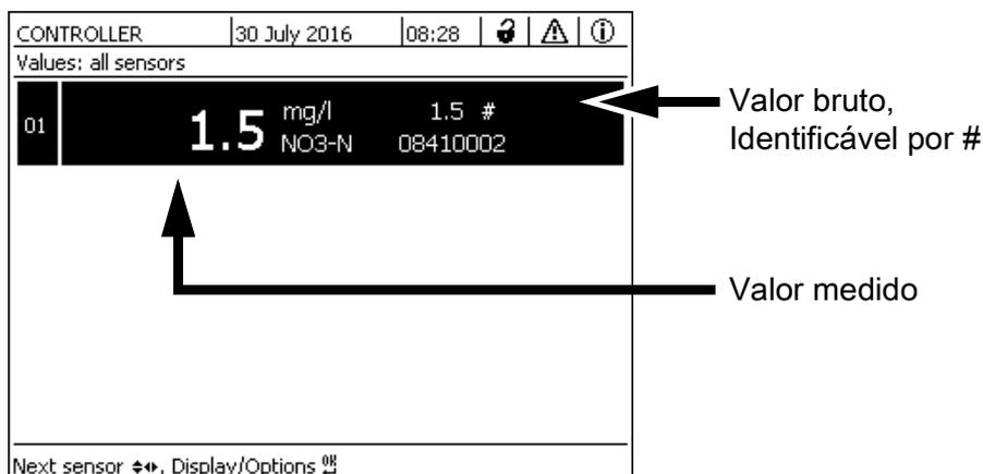
figura 4-2 UV 70x IQ NOx na visualização do valor medido
