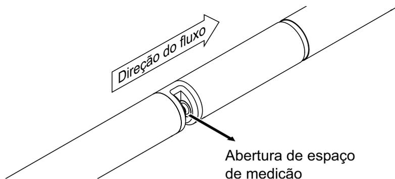
figura 3-1 Instalação horizontal
