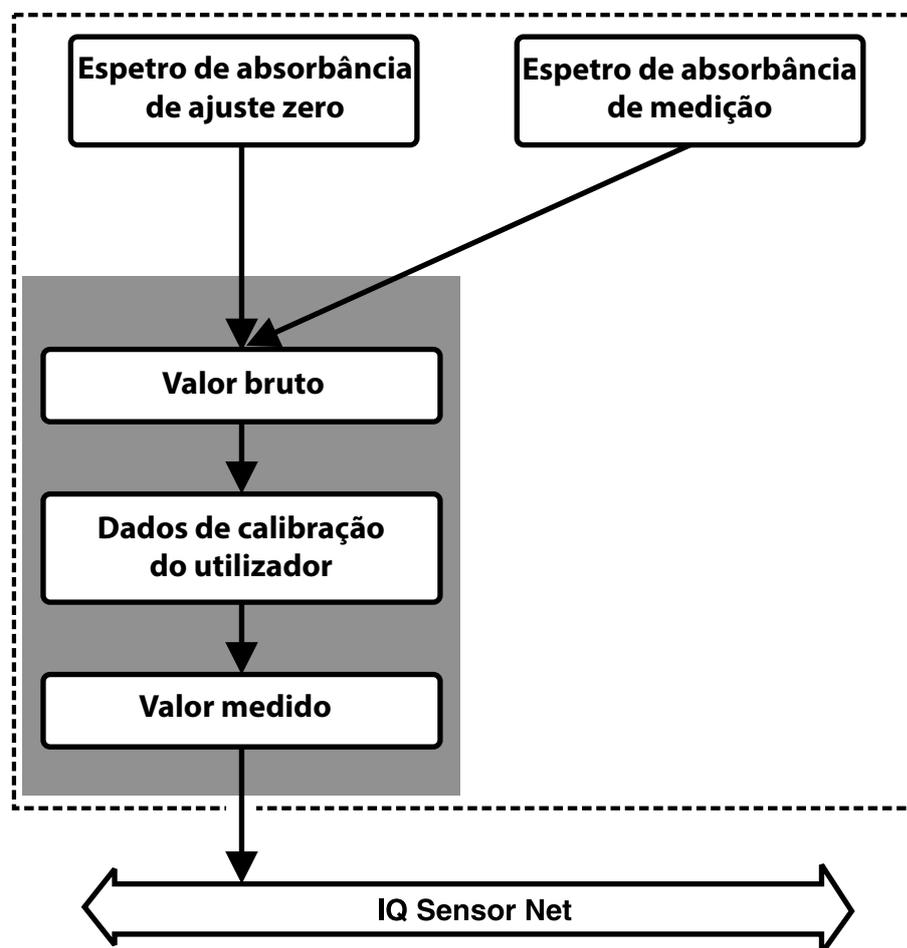
figura 4-1 Determinação dos valores medidos
